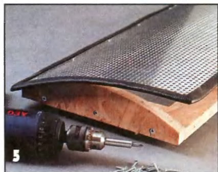
На кромки металлической обшивки дверки одевают резиновую прокладку и крепят лист обшивки шурупами к держателям.
