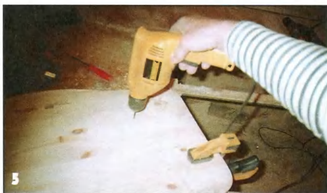
Центры глухих отверстий \varnothing 35 мм под короткие стойки намечаю сверлом \varnothing 1,5 мм, а затем сверлю в этих местах отверстия нужного диаметра.
