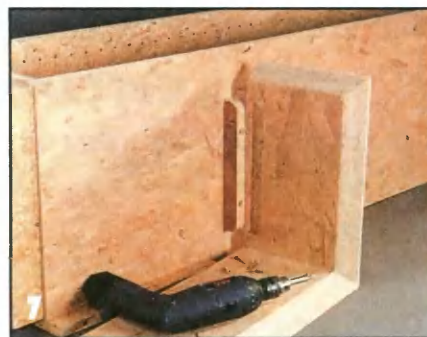
Выпиленную из плиты полосу крепят к боковой стенке шкафчика. Полочку с предварительно скошенными кромками привинчивают шурупами, ввертываемыми сквозь полосу снизу.
