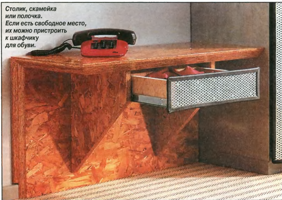
Из перфорированного стального листа делают и лицевую панель выдвижного ящика. Заготовку можно вырезать из листа ножницами по металлу.
