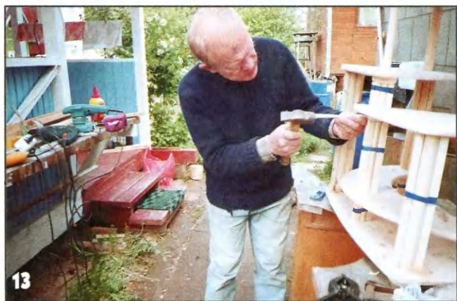
Опорные шайбы фиксируют шкантами длиной 70 мм, которые забивают на клею в заранее просверленные отверстия.
