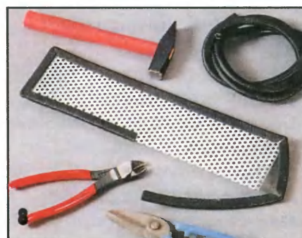
Из перфорированного стального листа делают и лицевую панель выдвижного ящика. Заготовку можно вырезать из листа ножницами по металлу.
