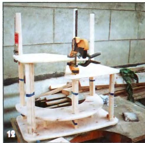
Обе детали третьей полки приклеиваю поочередно, также предварительно установив соответствующие ограничители высоты.
