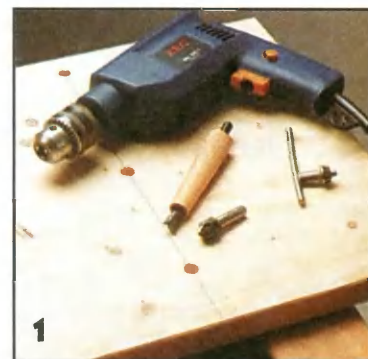
Разметив положение полок на боковых стенках, в них сверлят и зенкуют глухие отверстия Ø 12 мм. На сверло устанавливают ограничитель глубины сверления.
