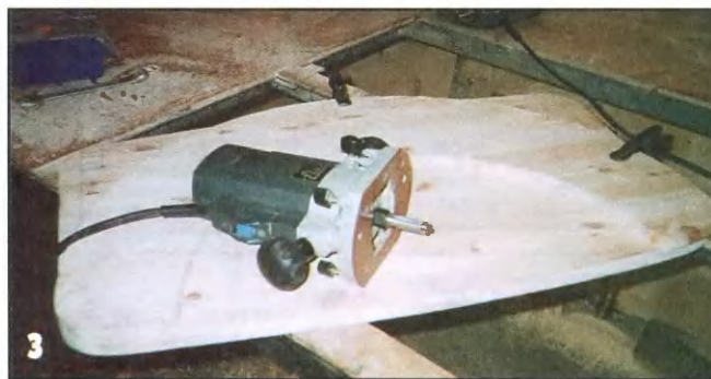
Прижав струбцинами полку к основанию, фрезерной машинкой с фрезой с направляющим подшипником убираю выступающие за основание свесы полки.
