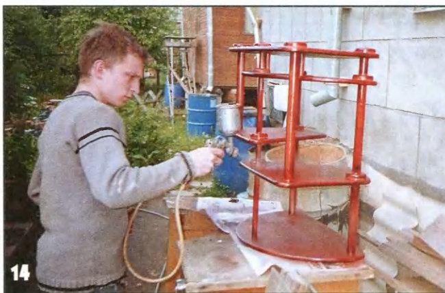
Жардиньерку окрашивают морилкой и лакируют, начиная с нижних поверхностей полок (на фото).
